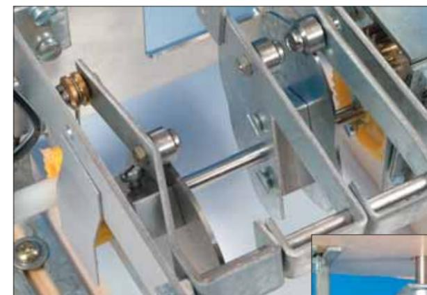
Die Exzentrerscheiben im Detail. Die hier gezeigte Position entspricht der Grundstellung wie im großen Bild.
